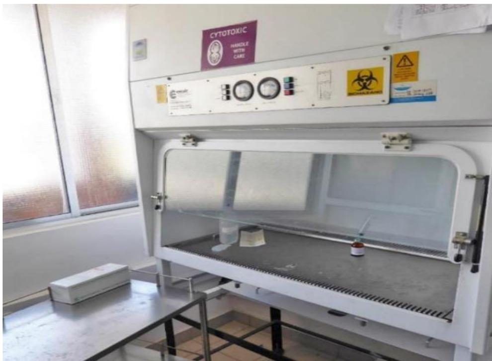
Figure 5 : Poste de sécurité cytotoxique (CSC) avec filtres HEPA et flux d'air laminaire (© Peter Vollmer)
